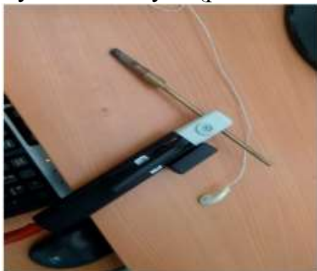
Рис. 1 Электрододержатель тренажера ДТС-02
